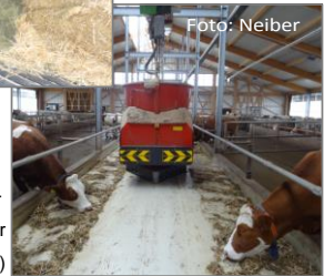
Futtermisch- und Verteilroboter (schiengeführt)
